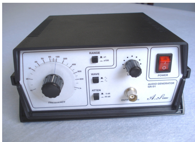
Fig. 8. Aspecto Externo do Gerador.
